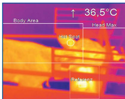
Infrarotthermografie zur Messung der Körpertemperatur bei einem Kalb.
