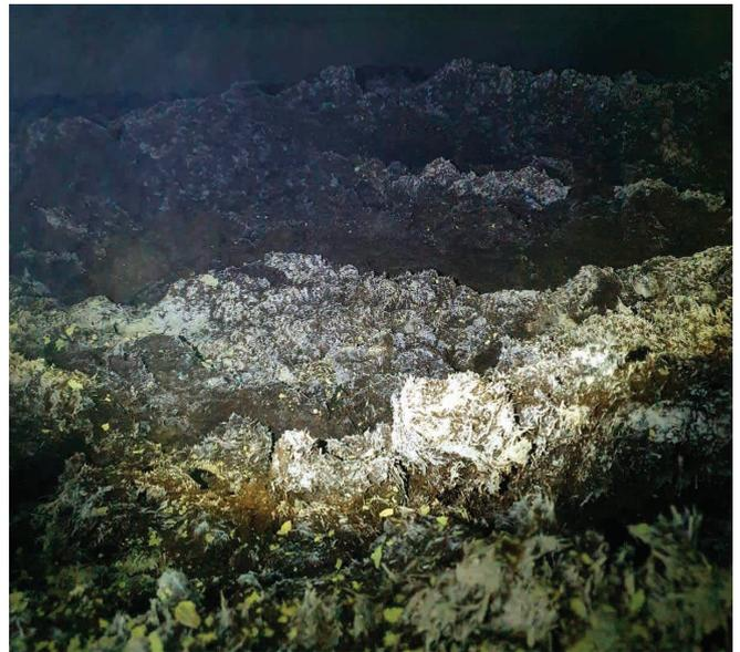
Abb. 15: Schwimmschicht im Fermenter
