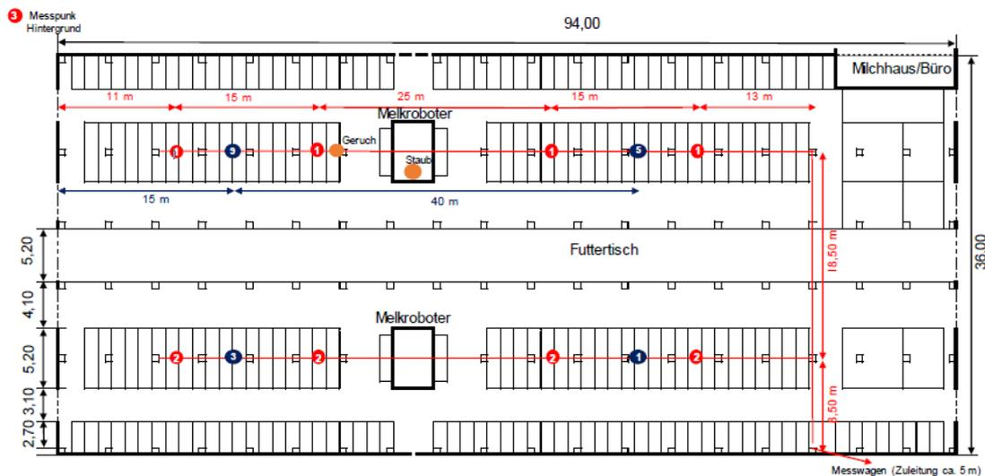
Abbildung 2: Schematische Darstellung des Messaufbaus der Stallmessungen (rot= die Messleitungen mit den einzelnen Öffnungen, blau= die Standorte der Temperatur- und Feuchtemessung, gelb= die Probenahmestellen für Staub und Geruch)
