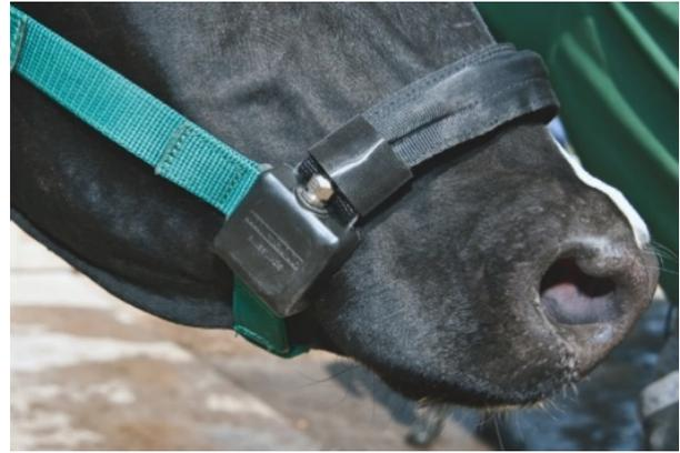
Abbildung 2: Sitz des Druckschlauches auf der Nase bei angelegtem RW-Messhalfter (Quelle: ITIN+HOCH)
