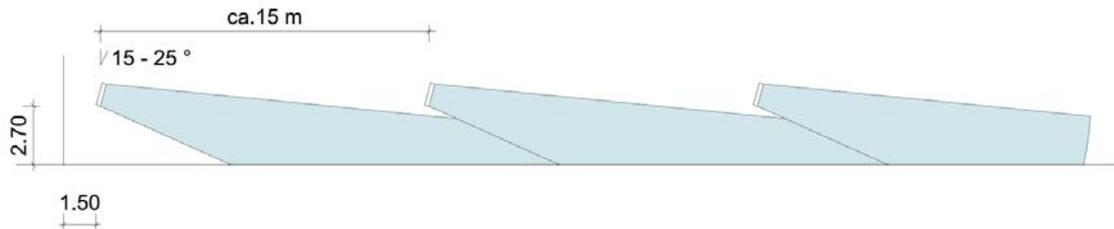
Abbildung 1: Einbauempfehlung für Ventilatoren in Längsrichtung
