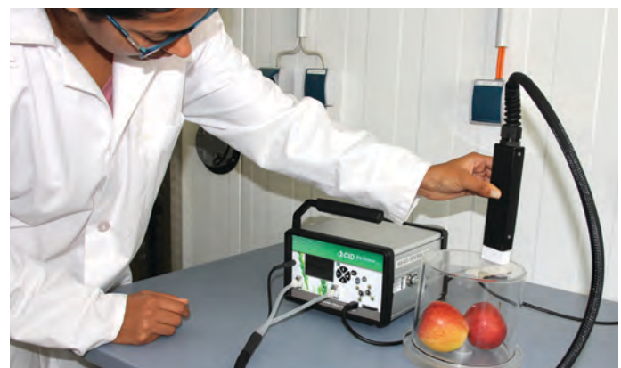
Ethylen-detektor (ETD-300, Nachweisgrenze bei 0,3 ppbv) für Messungen der Ethylenproduktion sehr geringer Konzentration. (Foto: ATB)
