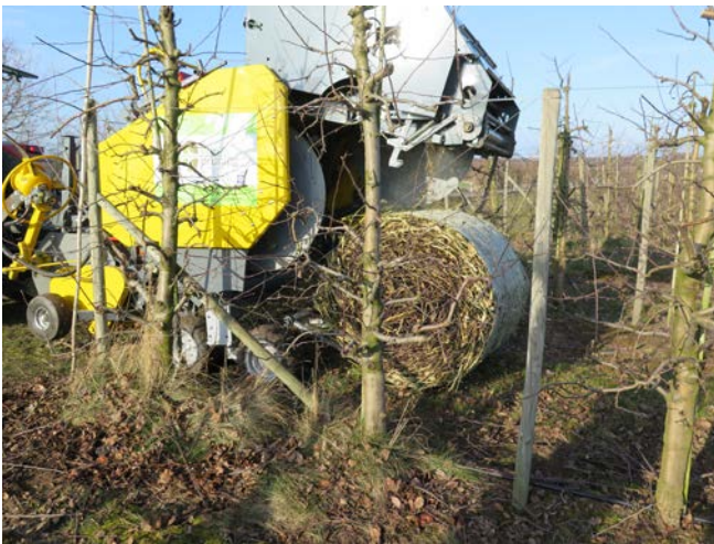
Die im Projekt EuroPruning entwickelte Ballenpresse im Praxistest (Foto: Germer/ATB)
