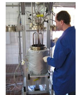
Autoklav im Technikum zur Herstellung von Biokohle, ATB
